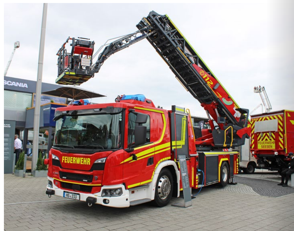
AUTOMOBILOVÝ ŽEBŘÍK NA PODVOZKU SCANIA, SE ZALAMOVATELNOU POSLEDNÍ ČÁSTÍ ŽEBŘÍKOVÉ SADY
