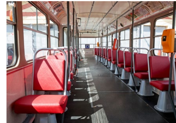
INTERIÉR VOZU 6312 ODPOVÍDÁ DOBĚ PO ZAHÁJENÍ PROVOZU PRAŽSKÉHO METRA, TZN. KOŽENKOVÉ SEDAČKY ČI KOŽENKOVÁ TAPETA NA SLOUPCÍCH OKEN A DVEŘÍ. SKŘÍŇ VOZU JE NÁSLEDNĚ VYBAVENA NAPŘÍKLAD OKRASNÝMI HLINÍKOVÝMI LIŠTAMI, ALE I NÁPISY „VSTUP A VÝSTUP“
