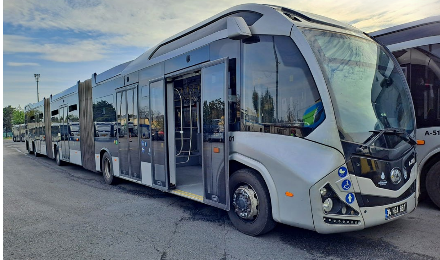
PĚTINÁPRAVOVÝ DVOUKLOBOVÝ AUTOBUS AKIA ULTRA LF 25 JE NEJDELŠÍM VOZIDLEM VE FLOTILE ISTANBULSKÉHO DOPRAVCE. ČTVRTÁ A PÁTA NÁPRAVA JSOU HNANÉ A PÁTA NÁPRAVA JE NAVÍC ŘIDITELNÁ. AUTOBUS POJME AŽ 280 CESTUJÍCÍCH
