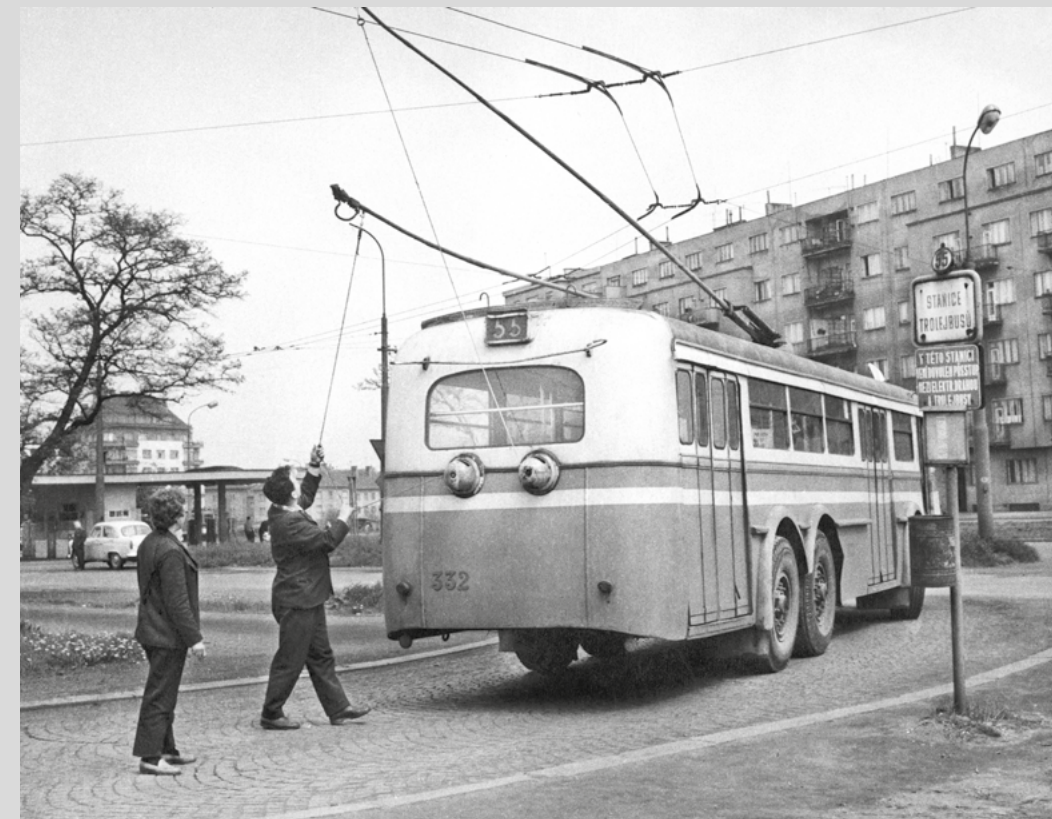
KONTROLA SBĚRAČŮ TROLEJBUSU T400 NA KONEČNÉ STANICI LINKY 55 U AUTOBUSOVÉHO NÁDRAŽÍ PANKRÁC
