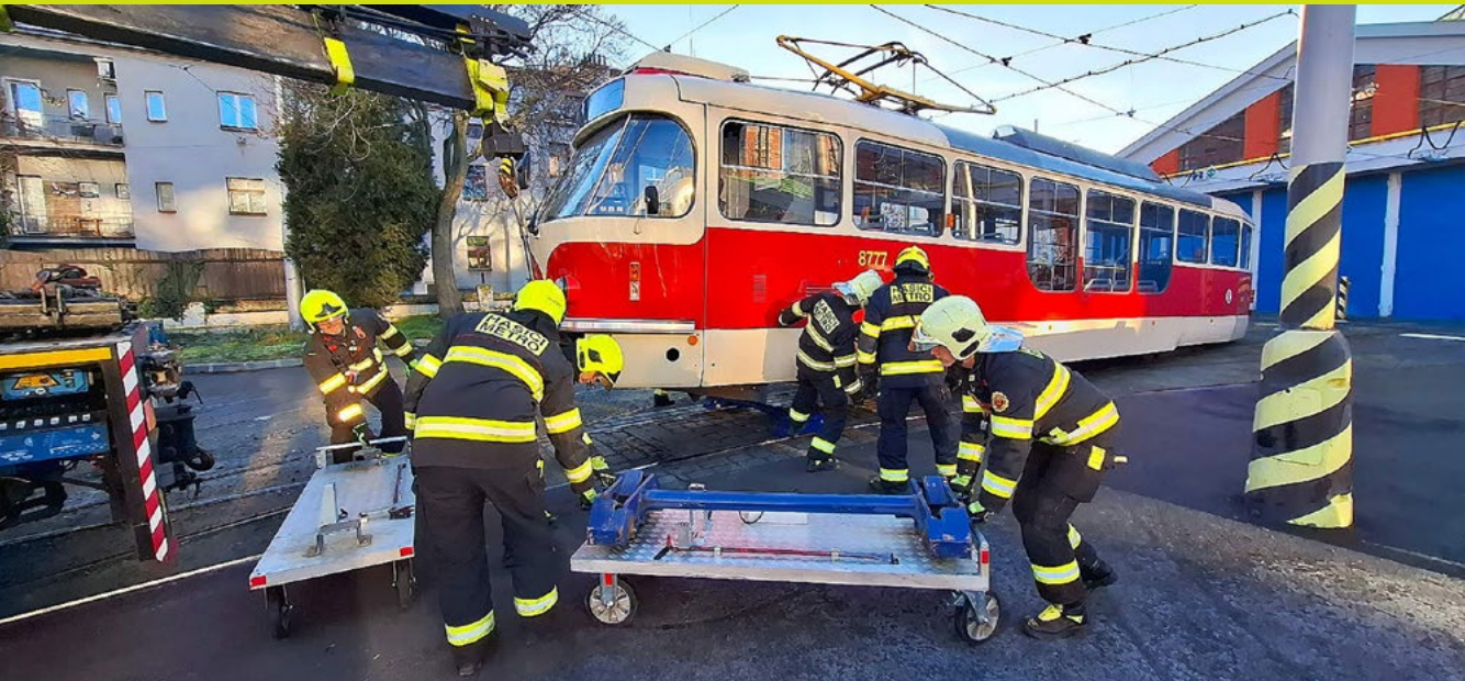
HAVARIJNÍ PODVOZEK PRO TRAMVAJ T3, VOZOVNA STRAŠNICE, 27. 12. 2025
