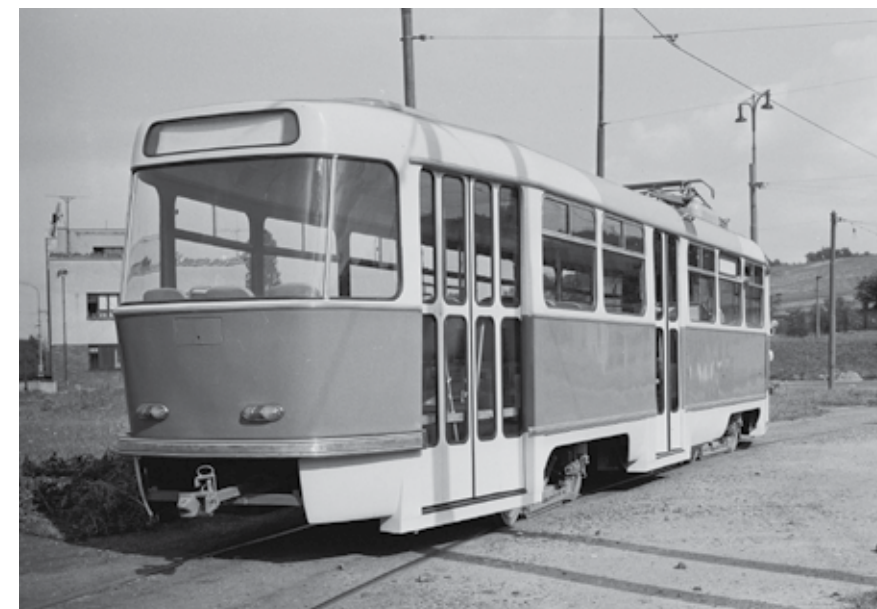
PROTI SÉRIOVÝM VOZŮM BYL PROTYP T III NÁPADNÝ MJ. NESYMETRICKÝMI ROZMĚRY DVEŘÍ (PODOBŇE JAKO TRAMVAJE T I A T II) A TRANSPARENTEM INTEGROVANÝM V HORNÍ ČÁSTI ZADNÍHO ČELA. SNÍMEK BYL POŘÍZEN NEDLOUHO PO DOKONČENÍ TRAMVAJE PRO PREZENTACI NA MEZINÁRODNÍM VELETRHU BRNO 1960 NA NÁDVOŘI PRAŽSKÉ VOZOVNY MOTOL V SRPNU 1960 SBÍRKA: ROBERT MARA
