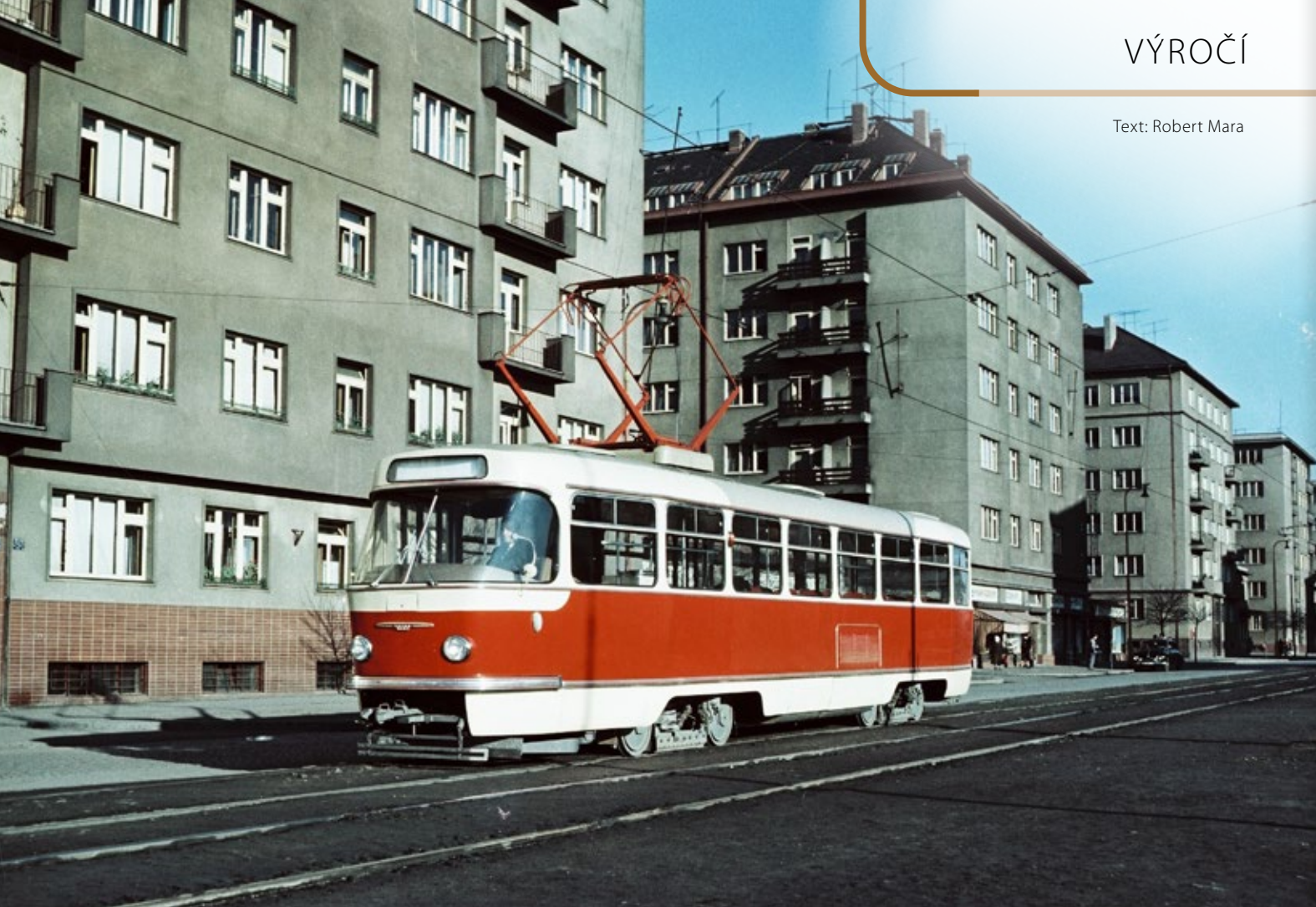
ELEGANTNÍ PROTOTYP T III PŘI ZKUŠEBNÍ JÍZDĚ PO TEHDEJŠÍ TRIDĚ SNB (POBLÍŽ DNEŠNÍ ZASTÁVKY SLAVIA), KUDY VEDLA TRASA LINKY Č. 4 OBSLUHOVANÁ ČTYŘNÁPRAVÝMI TRAMVAJEMI. ELEGANTNÍ VZHLED PŘEDNÍHO ČELA PODTRHOVALY SFÉRIČKÉ SVĚTLOMETY BOSCH A EMBLÉM VÝROBCŮ. TYTO PRVKY JIŽ NA SÉRIOVÝCH VOZECH BOHUŽEL NEBYLY. LEDEN 1961 FOTO: VŮKV
