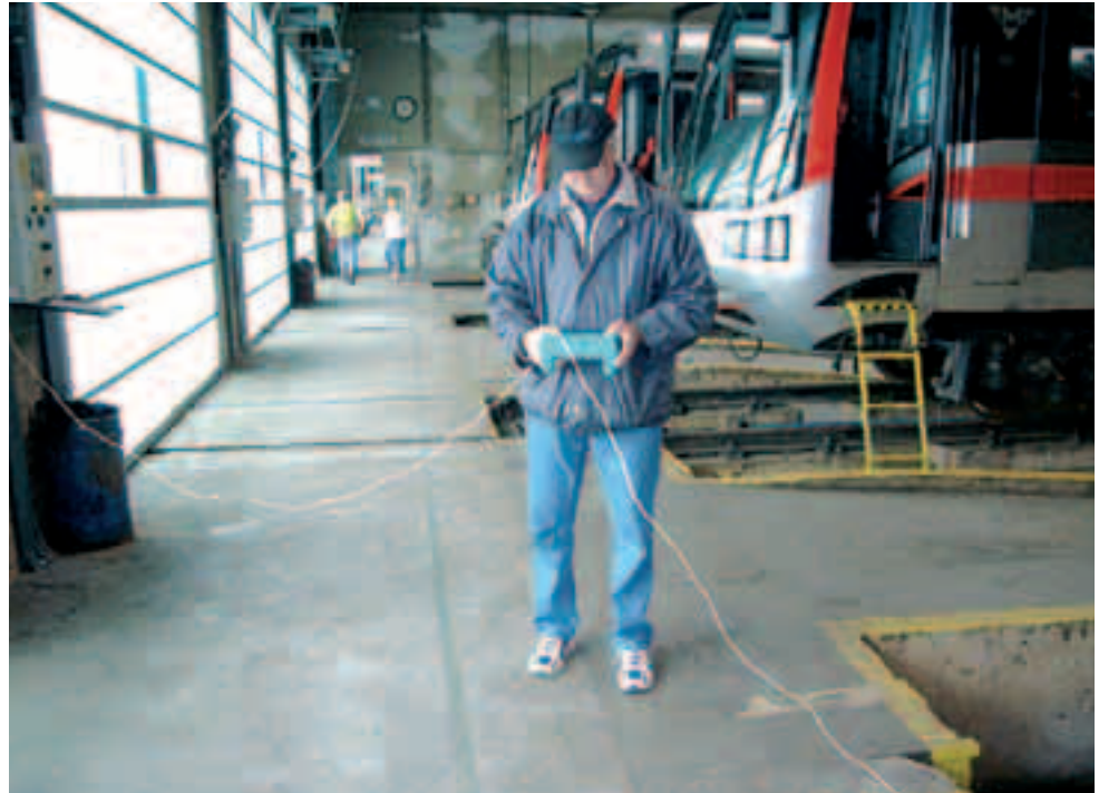
Měření izolace kolejí v hale depa.
