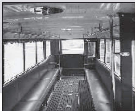
Podélné lavice, v tomto případě u autobusu Tatra 24/58 čalouněné, byly typické pro autobusy až do konce 40. let.
