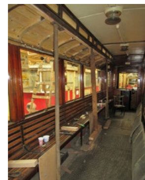
VŮZ 2239 Z ROKU 1930 SICE PROŠEL V SEDMDESÁTÝCH LETECH OPRAVOU, ALE STŘECHA Z MĚKKÉHO DŘEVA SE ZAČALA PROHÝBAT. PROTO BYLO V TOMTO ROCE PŘEVEDENO ZPEVNĚNÍ NÁSTŘEŠKU, ABY MOHLY BÝT VYJMUTY PODPĚRY STROPU V INTERIÉRU
