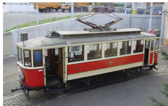
VŮZ 2239 Z ROKU 1930 SICE PROŠEL V SEDMDESÁTÝCH LETECH OPRAVOU, ALE STŘECHA Z MĚKKÉHO DŘEVA SE ZAČALA PROHÝBAT. PROTO BYLO V TOMTO ROCE PŘEVEDENO ZPEVNĚNÍ NÁSTŘEŠKU, ABY MOHLY BÝT VYJMUTY PODPĚRY STROPU V INTERIÉRU
