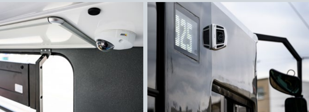
PŘEHLED VE VOZE A V JEHO OKOLÍ ZAJIŠTUJE I VNĚJŠÍ/VNITŘNÍ KAMEROVÝ SYSTÉM VČETNĚ ČELNÍ NEHODOVÉ KAMERY. ZOBRAZENÍ NA OBRAZOVKÁCH NA STANOVISTI ŘIDIČE JE PODOBNÉHO ROZVRŽENÍ JAKO VE VOZECH ŠKODA 15T (TZV. KVADRANT)
