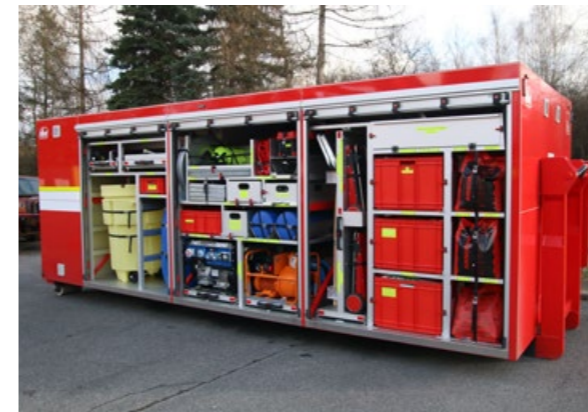
TŘETÍM NOVÝM KONTEJNEREM VE SLUŽBÁCH HZS JE KONTEJNER PRO LIKVIDACI ROPNÝCH HAVÁRIÍ. JEHO SPECIÁLNÍ VÝBAVA ČÍTÁ DESÍTKY POLOŽEK
