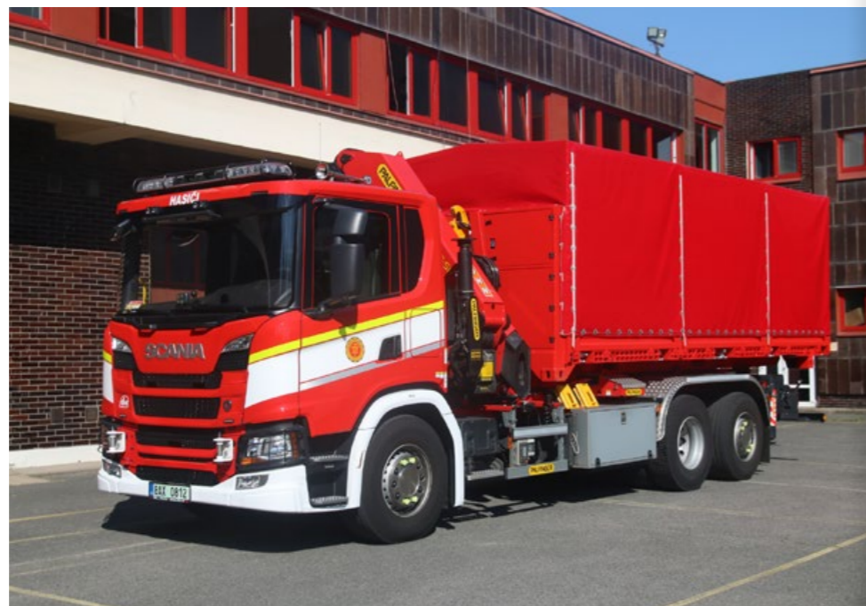
NÁKLADNÍ KONTEJNER JE KONCIPOVÁN JAKO VALNÍK S DĚLENÝMI BOČNICEMI A PLACHTOU, KONSTRUKCE JE SNADNO ROZEBÍRATELNÁ. PŘEVÉZT JE MOŽNÉ NAPŘ. I Tzv. ISO KONTEJNERY
