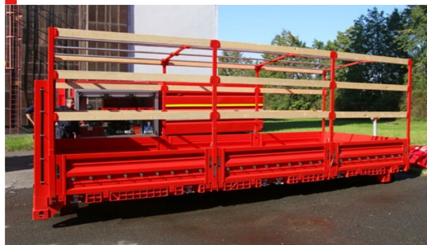
NÁKLADNÍ KONTEJNER JE KONCIPOVÁN JAKO VALNÍK S DĚLENÝMI BOČNICEMI A PLACHTOU, KONSTRUKCE JE SNADNO ROZEBÍRATELNÁ. PŘEVÉZT JE MOŽNÉ NAPŘ. I Tzv. ISO KONTEJNERY
