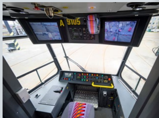
PŘEHLED VE VOZE A V JEHO OKOLÍ ZAJIŠTUJE I VNĚJŠÍ/VNITŘNÍ KAMEROVÝ SYSTÉM VČETNĚ ČELNÍ NEHODOVÉ KAMERY. ZOBRAZENÍ NA OBRAZOVKÁCH NA STANOVISTI ŘIDIČE JE PODOBNÉHO ROZVRŽENÍ JAKO VE VOZECH ŠKODA 15T (TZV. KVADRANT)
