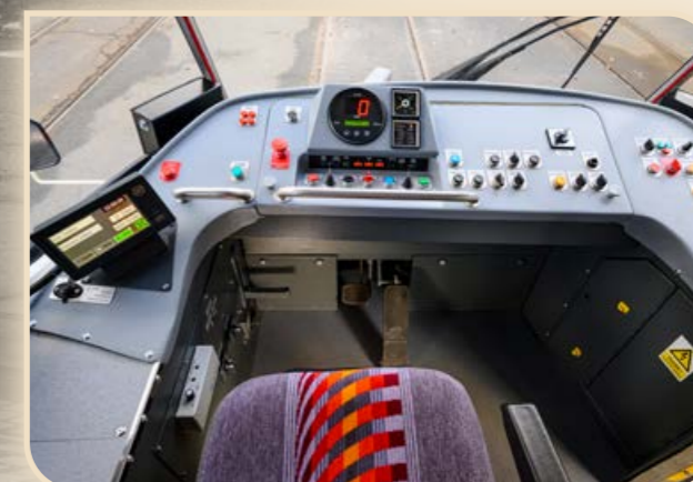
Nová povrchová úprava štítků tlačítek a přepínačů, instalace prvků pro zlepšení komfortu pro řidiče (podnožka pro levou nohu, držák na desky VJŘ a provozní výkazy, držák nápojů, háček na klíče, jiné provedení stropních svítlen shodných s osvětlením schodů atd.)
