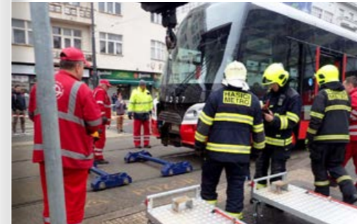
2. 4. 2022 – INSTALACE HAVARIJNÍHO PODVOZKU PRO TRAMVAJ ŠKODA 15T, VINOHRADSKÁ UL.
