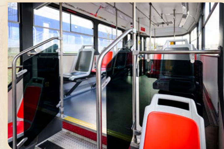
Kouřové zástěny schodů
