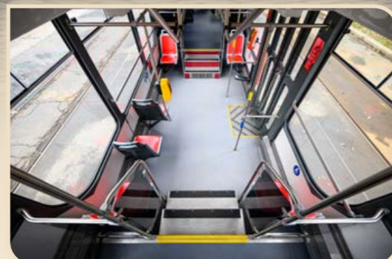
Dvoubarevná podlaha zlepšující komfort pro osoby se sníženou schopností pohybu a orientace
