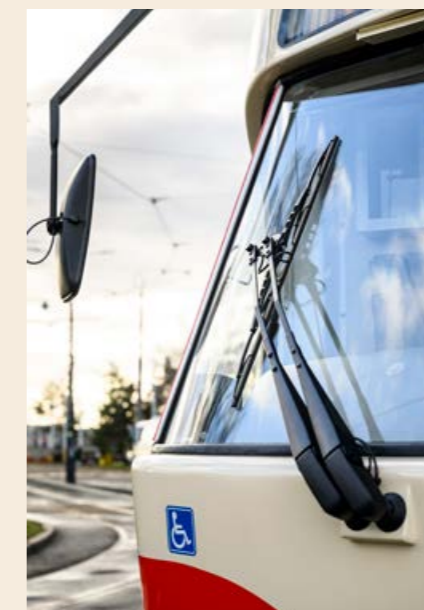
STĚRAČ JE NOVĚ JEDNOLÍSTOVÝ. ZPĚTNÉ ZRCÁTKO JE NOVĚ ELEKTRICKY OVLÁDANÉ
