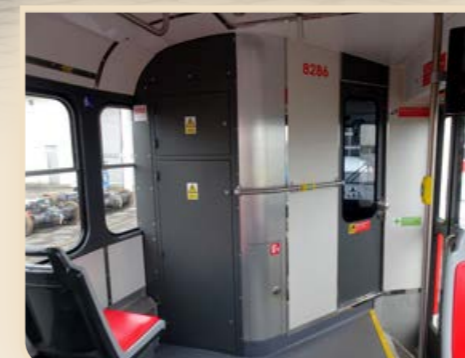
Nová povrchová úprava štítků tlačítek a přepínačů, instalace prvků pro zlepšení komfortu pro řidiče (podnožka pro levou nohu, držák na desky VJŘ a provozní výkazy, držák nápojů, háček na klíče, jiné provedení stropních svítlen shodných s osvětlením schodů atd.)
