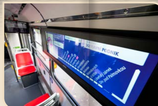
Nový vnitřní odbavovací a informační systém (OIS) včetně dvou monitorů (jeden za kabinou řidiče, druhý nad plošinou)
