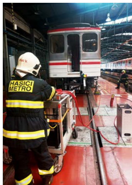
6. 10. 2022 – INSTALACE HAVARIJNÍHO PODVOZKU POD SOUPRAVU METRA, DEPO HOSTIVÁŘ
