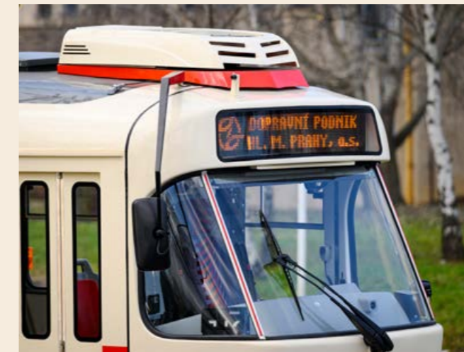
VŮZ OBDRŽEL KLIMATIZACI V KRÉMOVÉ BARVĚ A NOVÝ OIS BUSTEC
