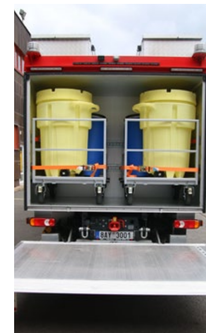
ZADNÍ ÚLOŽNÁ ČÁST S VOZÍKY PRO NÁDOBY NA KONTAMINOVANÝ MATERIÁL
