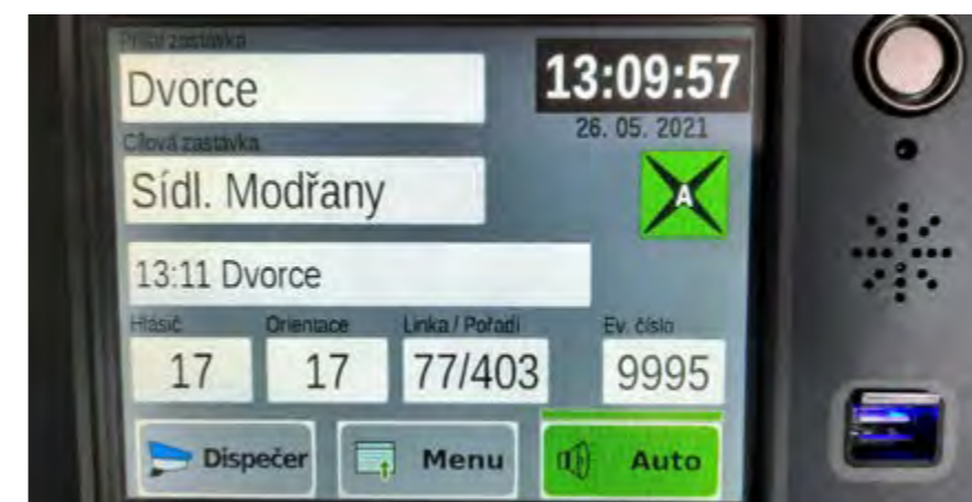
INFORMACE NA DISPLEJI PALUBNÍHO POČÍTAČE O ČASE ODJEZDU SPOJE Z NEKONTROLNÍHO BODU
