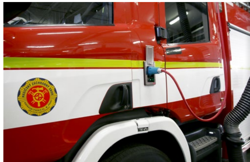
UMÍSTĚNÍ DOBÍJENÍ NA PRVOVÝJEZDOVÉM VOZE CAS 20 SCANIA
