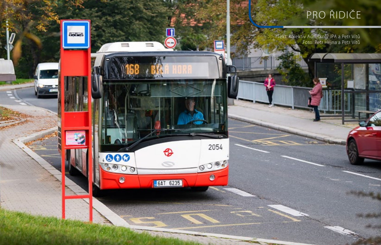
AUTOBUS STANICUJE V ZASTÁVCE V TZV. ZÁLIVU. NA PROTĚJŠÍ STRANĚ JE ZASTÁVKA JINÉHO TYPU – V JÍZDNÍM PRUHU
