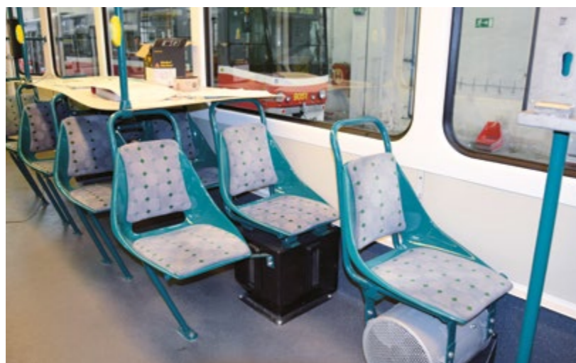
NOVÉ ZASKLENÍ, PODLAHY, STROPY, OBLOŽENÍ, ZÁŘIVKY. TO JSOU NĚKTERÉ NOVÉ PRVKY, KTERÉ VOZY KT4D V PRAZE DOSTALY
