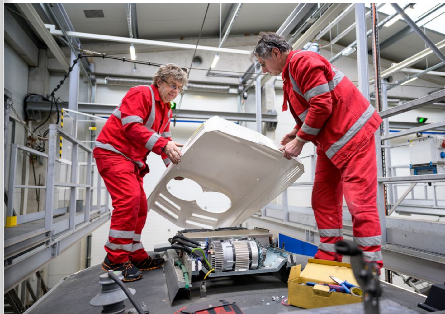
NA SNÍMKU S KOLEGOU STANISLAVEM CHRPOU PŘI SERVISU KLIMATIZACE NA TRAMVAJI KT
