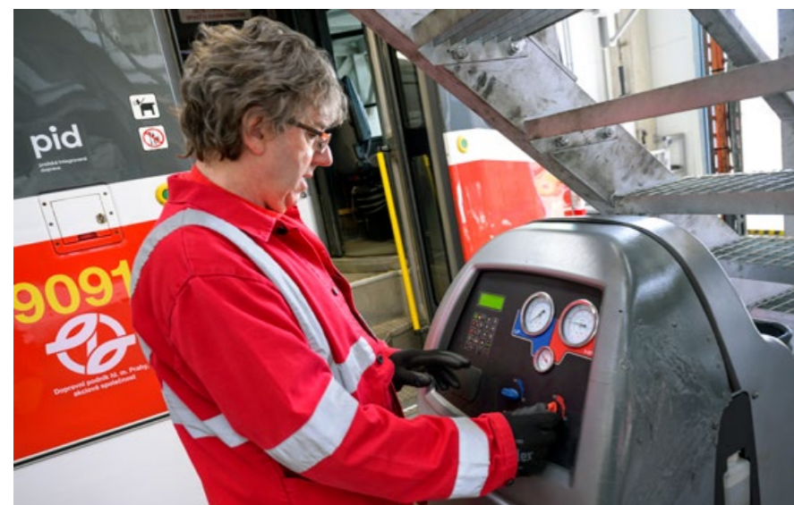
JIŘÍ KRČMÁŘ U DIAGNOSTICKÉHO PŘÍSTROJE PRO OPRAVU KLIMATIZOVANÉHO OKRUHU U TRAMVAJE KT
